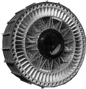
图 7 Tweel 轮胎在 NASA 月球车上的应用 Figure 7 Application of the Tweel tires on NASA lunar rover
