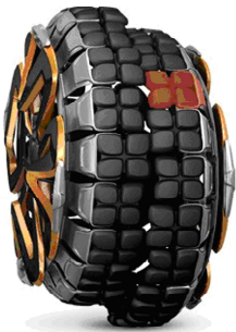
图 13 可变花纹轮胎——Motiv Figure 13 Pattern variable tire-Motiv
